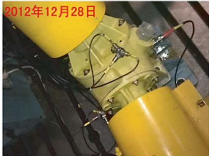
减速器试车台
