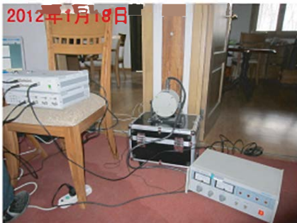
竹结构房屋抗振试验
