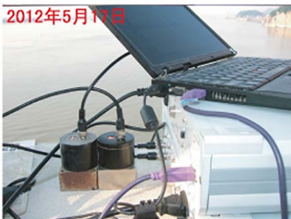
振动传感器连续监测5年后现场标定
