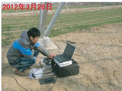
平度光泽线100塔振动应变离线测量
