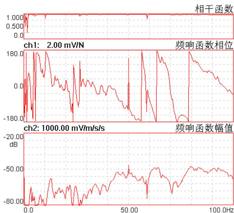
图（4）相干函数（上）与频率响应函数的相频（中）、幅频（下）
